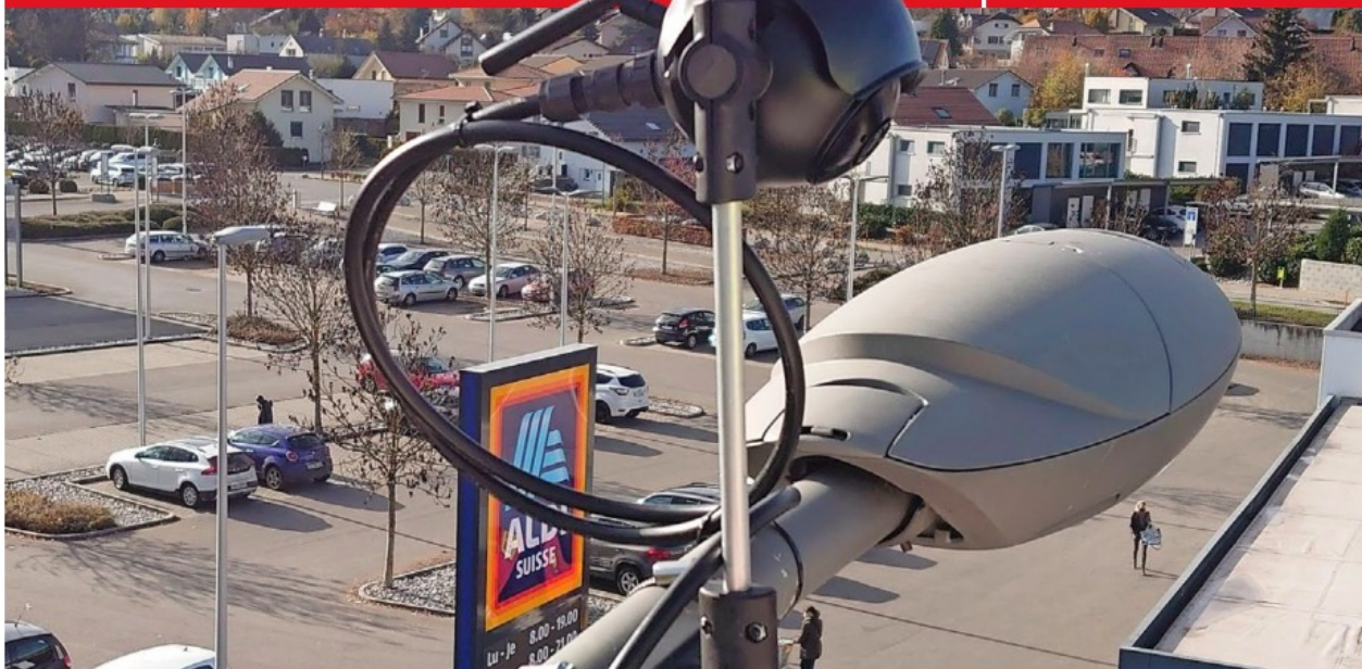
Une caméra thermique filme le trafic de la route de Riaz, à Bulle, et transmet les données via LoRa à une antenne disposée sur l'Hôtel de Ville. HEIA-FR
