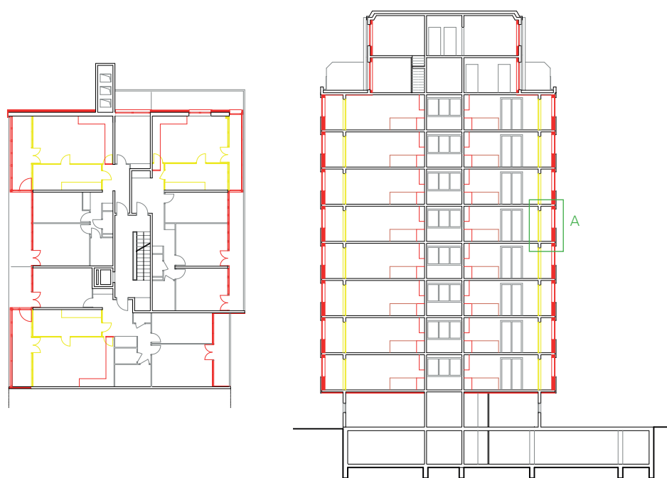
Plan (étages 1 à 8) et coupe schématiques. En rouge, les éléments de l'enveloppe isolés ou les nouveaux éléments du scénario et en jaune les éléments démolis.
