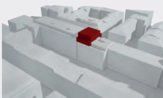
Scénario retenu (D) : démolition de l'attique existant pour reconstruire un niveau d'étage courant ainsi que surélévation d'un niveau d'attique.
