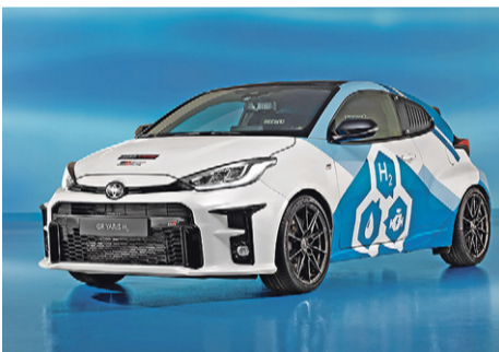
Als experimenteller Prototyp nutzt der Toyota Yaris GR Sport H2 (o.i.) Wasserstoff als Treibstoff. Die Vorkammertechnologie (o. M. und r.) ermöglicht eine stabile Verbrennung des Wasserstoffs. Der Einzylindermotor der Hochschule Freiburg (gr. Bild) läuft ebenfalls mit Wasserstoff.
