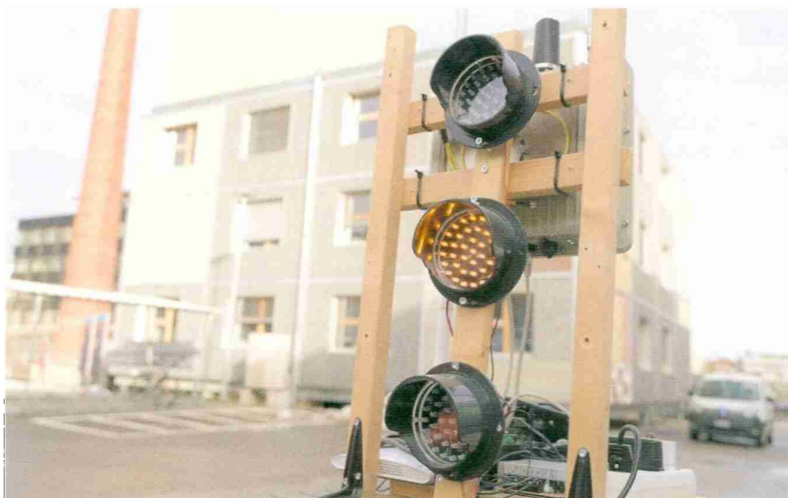
Figure 2 Feu de signalisation équipé de la RSU (boîte grise derrière le feu).
