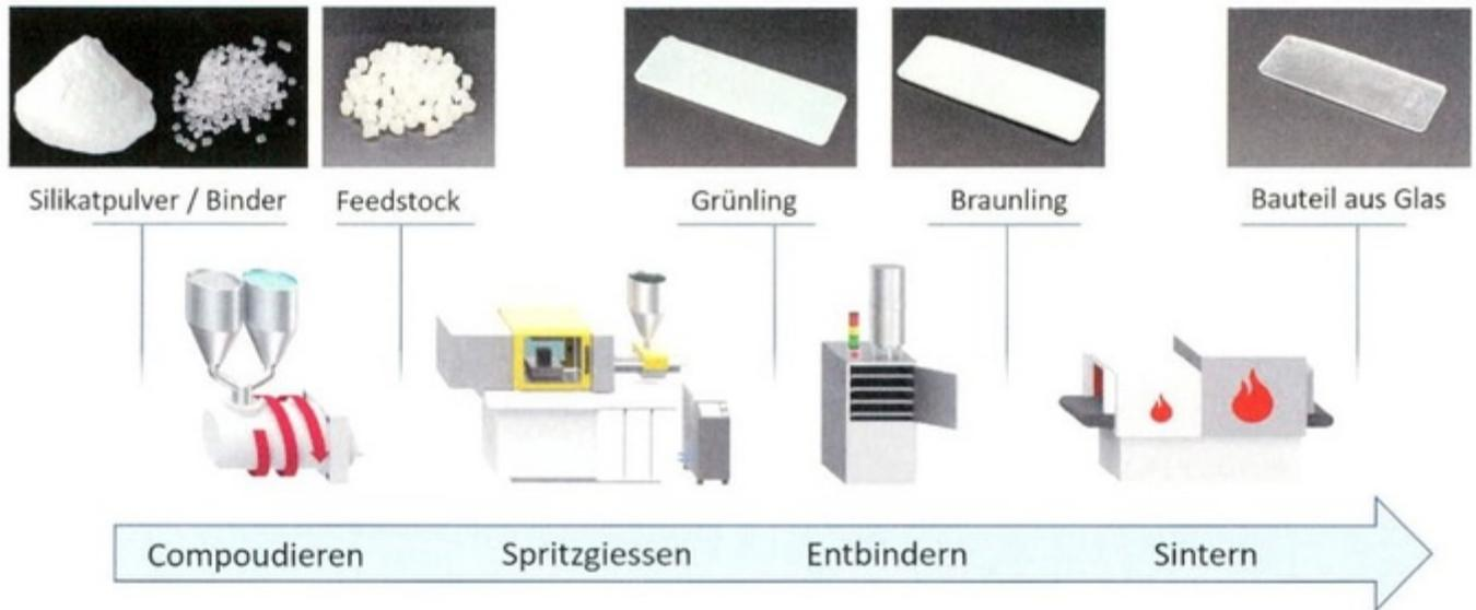
Bild 1: Die einzelnen Schritte des Glass Injection Molding (GIM)-Prozesses. (Quelle: IRAP/ALPS)
