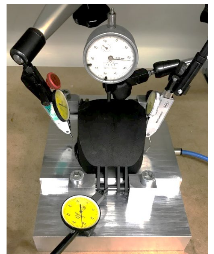
Banc de tests pour mesures de déplacements sous pression.
