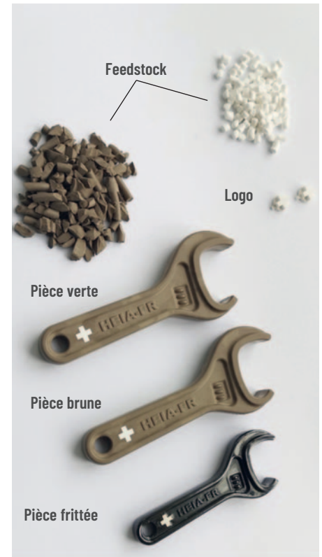
Fig. 4 : Les quatre étapes de base du processus CIM: préparation des matières premières, moulage par injection (pièce verte), délianté (pièce brune) et frittage (pièce frittée). Par ailleurs, la pièce intègre un logo par surmoulage.
