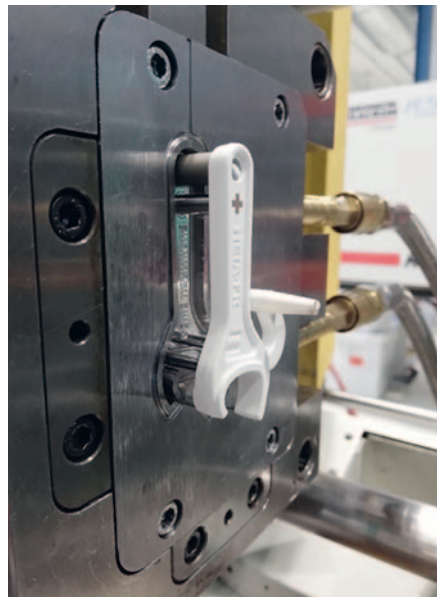
Fig. 2 et 3: Éjection de la pièce de démonstration montrant la faisabilité de l'intégration d'un logo à une pièce CIM par surmoulage.
