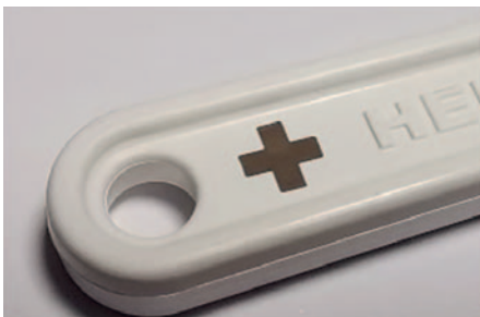
Fig. 2 et 3: Éjection de la pièce de démonstration montrant la faisabilité de l'intégration d'un logo à une pièce CIM par surmoulage.
